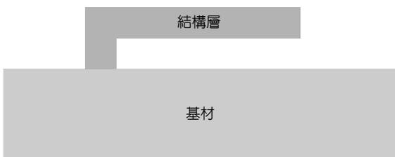
圖 3.25 微結構體的釋放，(a) 犧牲層移除前，(b) 犧牲層移除後。
